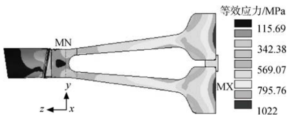
图 7 模型 1 的等效应力云图
