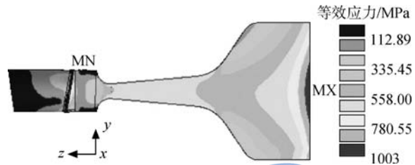
图 9 模型 3 的等效应力云图
